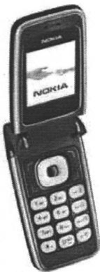
**Каждый сотовый телефонный аппарат имеет международный идентификационный номер IMEI, который состоит из 15 цифр (пример -356328-94-581873-3): первые 6 цифр - код конкретной модели телефона, вторые две - код страны-производителя, следующие 6 цифр - серийный номер телефона, последняя цифра - запасной идентификатор.**
